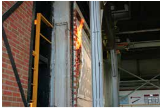
El American Wood Council (AWC) realizó un ensayo de Resistencia al fuego de acuerdo a la norma ASTM E119 en un muro CLT el año pasado en NGC Testing Services en Buffalo, Nueva York.
