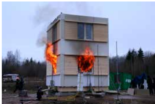
Ensayo de resistencia al fuego de una casa de CLT realizada por la Academia de Ciencias de Seguridad de Estonia (ENG). Sisekaitseakadeemia
